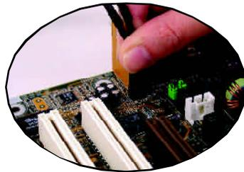
3. 將前置左右聲道插頭連接至音源輸出、後置左右環繞聲道插頭連接至 SURROUND-KIT 的 REAR R/L 輸出，中央重低音聲道插頭連接至 SURROUND-KIT 的 SUB CENTER 輸出。
