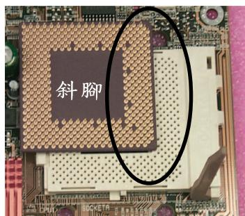
2. 將處理器的斜腳對準插座上的斜腳後，將處理器平行插入插座。
