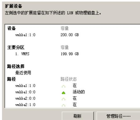
显示屏幕将包括有关各条指向设备的路径的状态信息。其中会出现以下路径信息：
