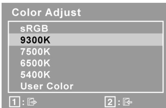
**sRGB** - 是一種顏色管理的工業標準，它支援很多最新的應用程式。啓用此設定，LCD 可以更精確地顯示原始色彩。啓用 sRGB 設定後將關閉 Contrast (對比度) 和 Brightness (亮度) 調整。
