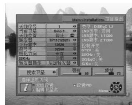
编辑模式：如果用户需要编辑某一预设的数据，如转发器、频率、符号率、极化和 22KHz 时，可按遥控器上的编辑模式键（红色键）。
