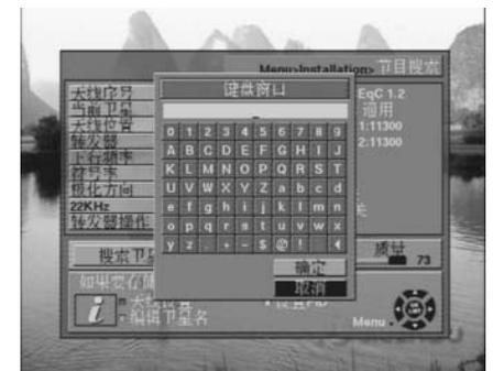
12. 删除转发器：如用户想删除一个转发器，请先选定想删除的转发器，再按遥控器上的 MENU 键显示命令框，选择删除转发器指令后，将显示一确认信息框。
