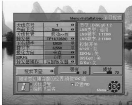
4. 转发器：用◀▶键选择想接收的转发器，也可按 OK 键，在显示的下拉菜单中选择欲接收的转发器。
