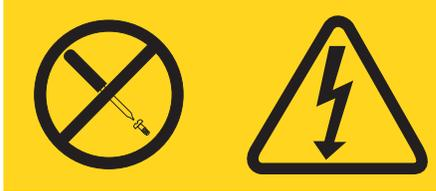
贴有此标签的所有组件内部都有危险的电压、电流和能量级别。这些组件内部没有可维修的部件。如果怀疑其中的某个部件有问题，请联系技术服务人员。
