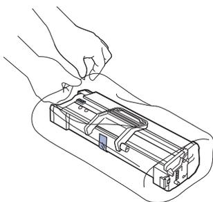
6. 撕开包装胶带，拆掉用于保护成像装置的仓盖。同时拆掉密封胶带。
