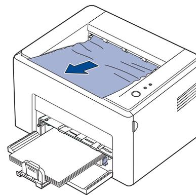
当您直接拉出卡住的纸张时，如果有阻力，且该纸张没有立即移动，请停止拉动纸张。继续执行下一步。
