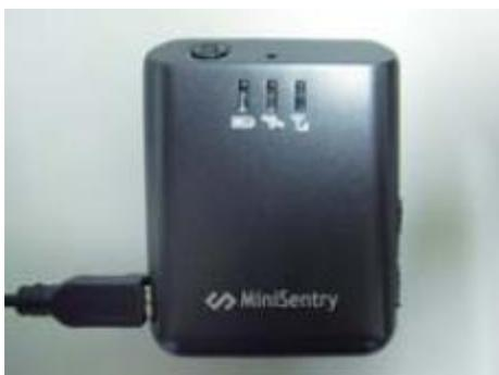
**【注意 1】** 電池第一次充電約需 4 至 6 小時，方可確保電池已完全充電完成；後續每次充電所需時間約為 2 至 4 小時。
