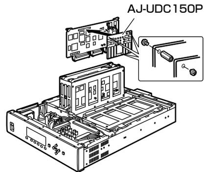
**5** F4スロットに基板を差し込み、基板固定金具を取り付け、ネジで固定します。
