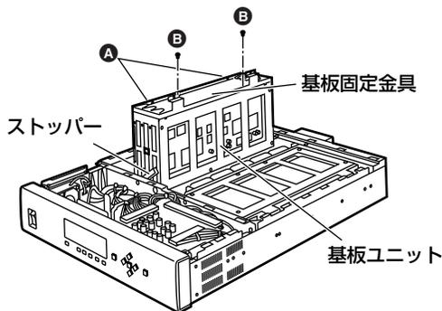
**3** **A**のネジ2本をゆるめ、**B**のネジ2本を外して基板固定金具を外します。
