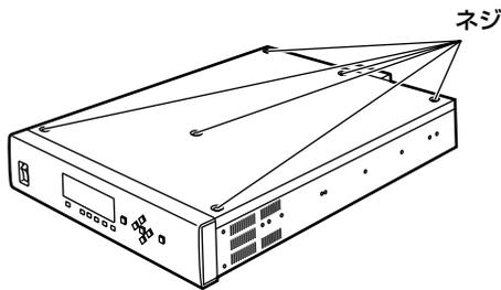
**2** ネジ2本を外し、基板ユニットを垂直に起こします。
