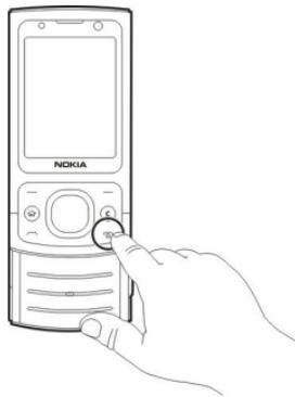
按住电源键可打开或关闭设备。快速按电源键可结束通话或关闭应用程序。
