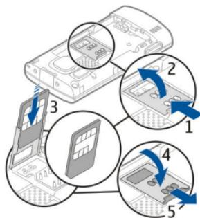
确保 SIM 卡的触点向下朝向设备, 并且切角向下朝向 SIM 卡卡夹。
