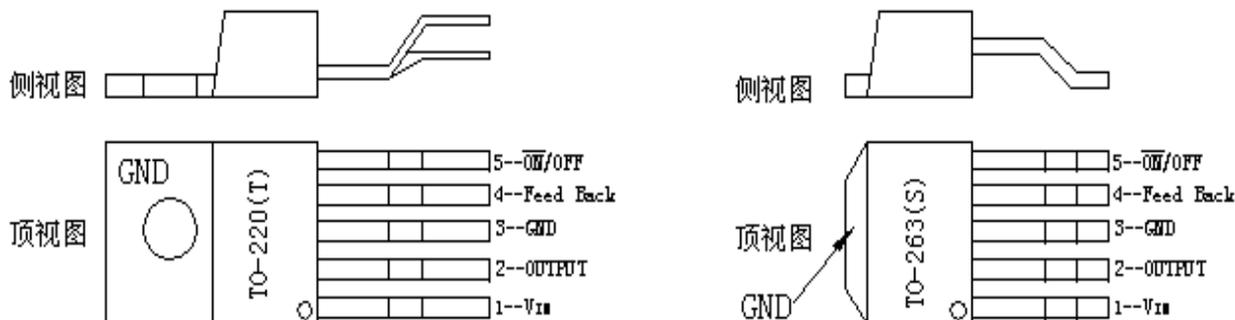
**V<sub>IN</sub>** 正輸入端，在這個管腳處必須加一個適當的輸入旁路電容來減小暫態電壓，同時為 LM2596 提供所需的開關電流。
