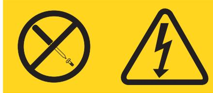
任何贴有该标签的组件内部都存在危险的电压、电流和能级。在这些组件中没有可维护的部件。如怀疑此类部件中的某一个有问题，请联系技术服务人员。
