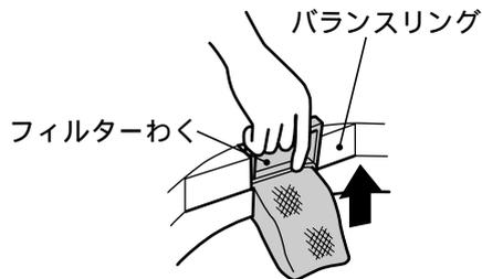
2 フィルターのネットを裏返して、糸くずを取り除き、目詰まりを洗い落とす。
