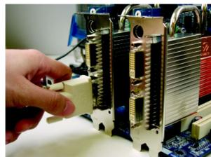
(Hinweis) Zum Aktivieren der SLI-Funktion muss das Monitorkabel an die Grafikkarte angeschlossen werden, die in der PCIE\_16\_1-Steckfassung eingeschoben ist.
