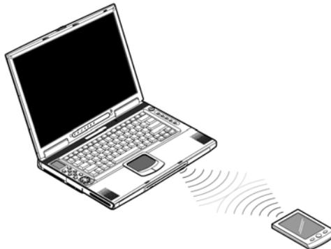
要使用紅外線功能時，兩個裝置的紅外線裝置不可超過 1 公尺，及 15 度角。當兩部裝置擺放位置正確後，您就可以開始傳送資料了。詳細檔案傳輸方法，請看傳輸軟體的說明。
