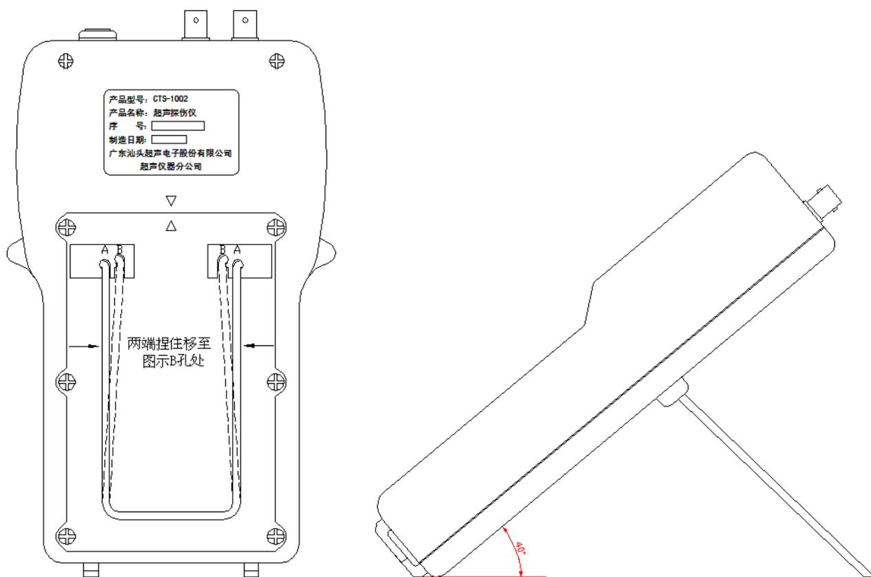
3、当支架两端处在 B 孔位置时，放下支架贴紧电池盖，支架两端会自动弹到 A 孔处。打开不锈钢支架，则仪器水平倾斜角为  $60^{\circ}$
