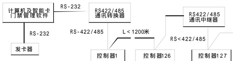
图5 加中继器增加控制器数量的系统连接示意图
