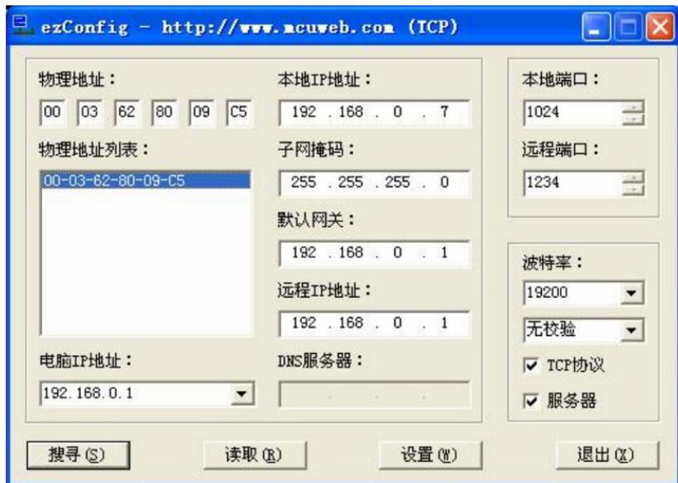
2、选中要配置转换器的物理地址后，界面其他部分变为有效。此时可以读取和设置转换器配置，可以重新读回相应转换器参数以确认更改有效。
