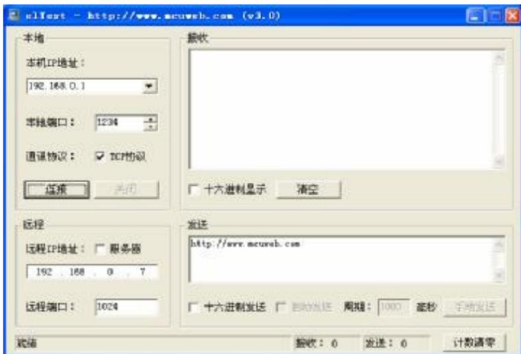
[本机 IP 地址] 选择本机的 IP 地址。程序自动搜寻电脑所有的 IP 地址,并将最可能的地址选中,如果不对,用户可以通过组合框选择;
