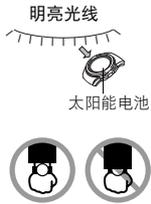
本表内藏的电池会储存由太阳能电池产生的电能。在不受光线照射的地方长时间放置或使用本表会使电池的电量耗尽。请尽可能地让手表照射到光线。
