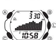
进入测高计模式会，按住 **(D)** 钮约 1 秒直至手表发出两声鸣音。此表示高度值的记录已被存入存储器。
