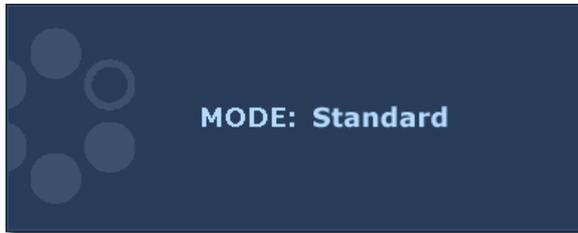
继续按下 **◀** 键可切换 6 种不同模式的主窗口，包括标准、电影、游戏、图片、sRGB 和省电。设置将立即生效。请参阅第 24 页的“Picture Mode (图像模式)”。
