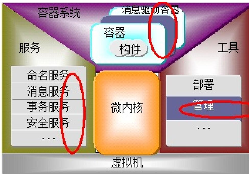
对于管理框架而言，图1红色圆圈中的模块都是平台管理的内容。在PKUAS管理框架体系中，管理框架通过操纵这些模块的元层实体来操纵这些模块的行为和表现。此外，管理框架与PKUAS的系统启动模块、JMS消息服务、安全服务存在直接交互关系。
