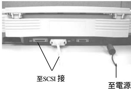
圖 2-7 連接電源線與SCSI訊號線
