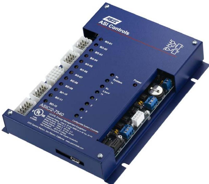
ASIC/2-7540 可作为与其它带有 ASI 控制器的大型通讯控制网络的一部分。基于系统总线和区域总线的 19200 波特的通讯速率，可快速取得与送出信息。这允许完整的机械系统以集成控制来最佳优化楼宇性能。温度、设定点和其它控制器信息可以很容易地被报告给 ASI WebLink 或任何基于 Windows 的程序控制 OPC 或动态数据交换 (DDE) 的客户端软件。
