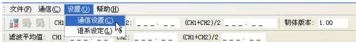
3. 出现通讯设定窗口，依照 DVP02LC 的模块设定通讯参数，通讯设定好后点选确定即跳回主画面。
