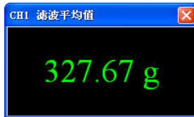
备注:未启动动态滤波功能时,滤波平均值窗口显示为 32767。如要启动动态滤波功能,请参考启动滤波功能条件为平均次数设定大于 30,并设定“滤波比例设定”参数。
