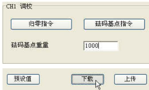
8. 点选「砝码基点指令」进行设定砝码基点设定，如下图所示。此时 CH1 重量显示等于 1000G。
