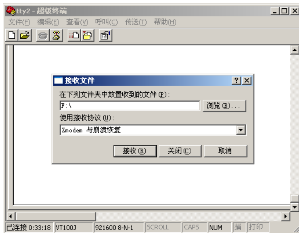
图 3.28 使用超级终端测试串行通讯端口(5)
