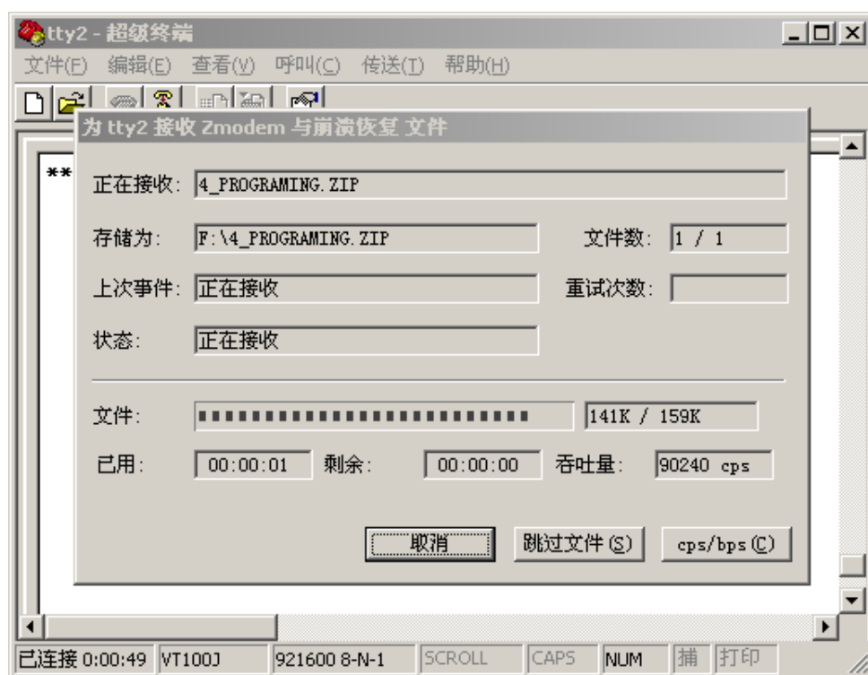
图 3.31 使用超级终端测试串行通讯端口(8)
