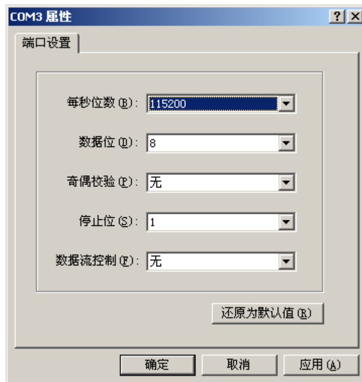
图 3.26 使用超级终端测试串行通讯端口(3)
