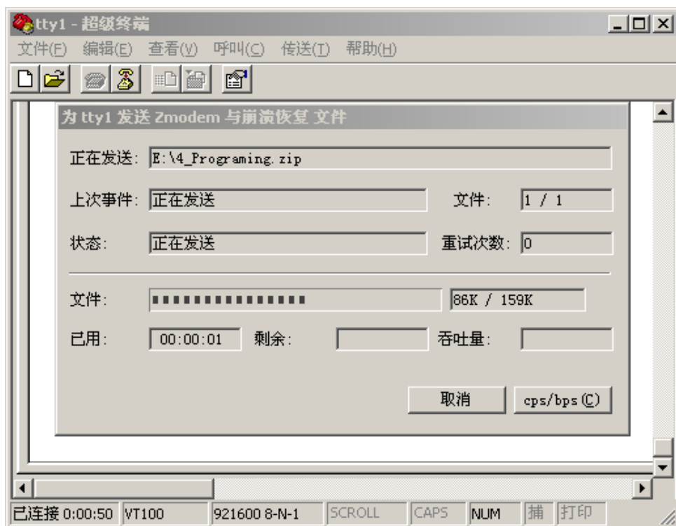
图 3.30 使用超级终端测试串行通讯端口(7)
