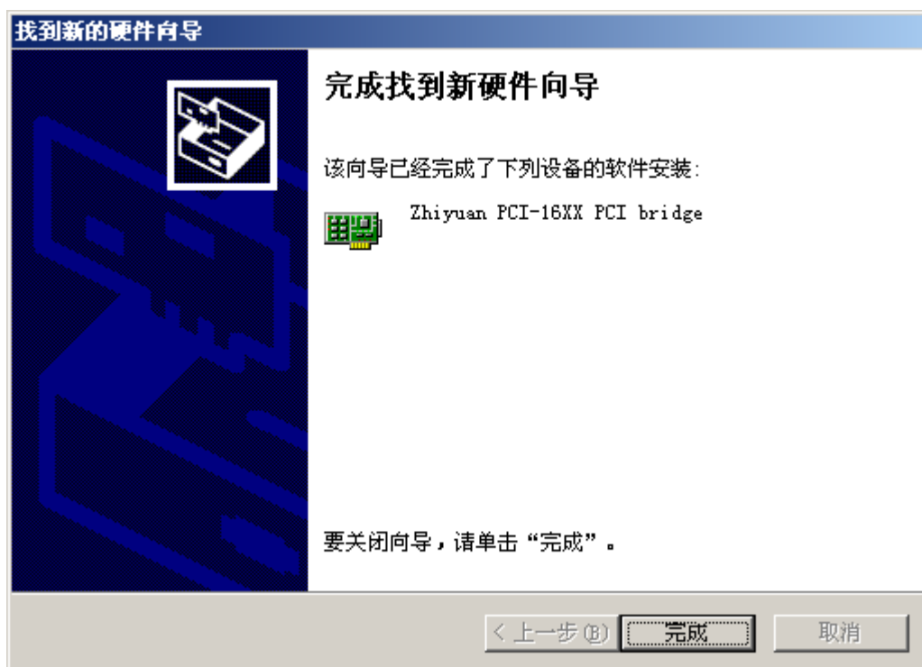
图 3.11 RS-422/485 多串口卡的驱动安装(5)
