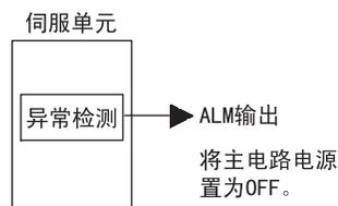
所构成的外部电路必须在该警报输出时使通向伺服单元的主电路电源置为 OFF。
