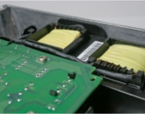
直流电抗器 内置直流电抗器，降低谐波，延长变频器使用寿命，并节省客户外置电抗器的空间和成本
