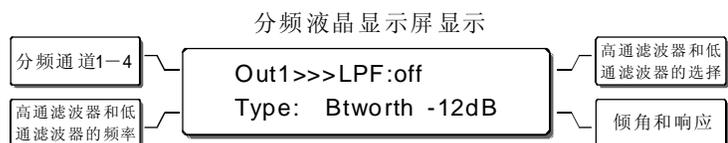
高通滤波器(HPF)的频率范围为从20.4Hz~20.9KHz，具有在频率选择低端时将滤波器关闭的选项。低通滤波器(LPF)具有相同的频率范围，具有在频率选择高端时将滤波器关闭的选项。
