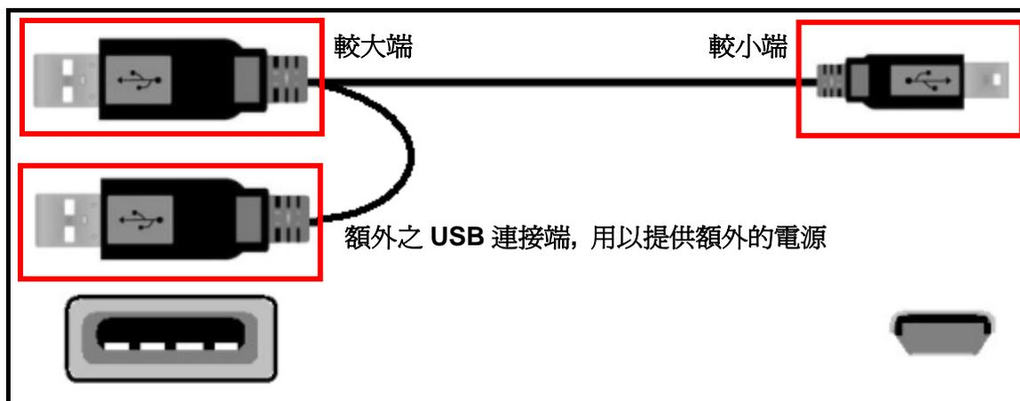
圖 7. Mini USB 轉 USB A-型連接線 (USB Y 型連接線)
