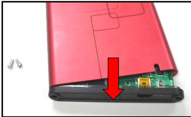
圖 3. 移除附有控制卡的蓋板
