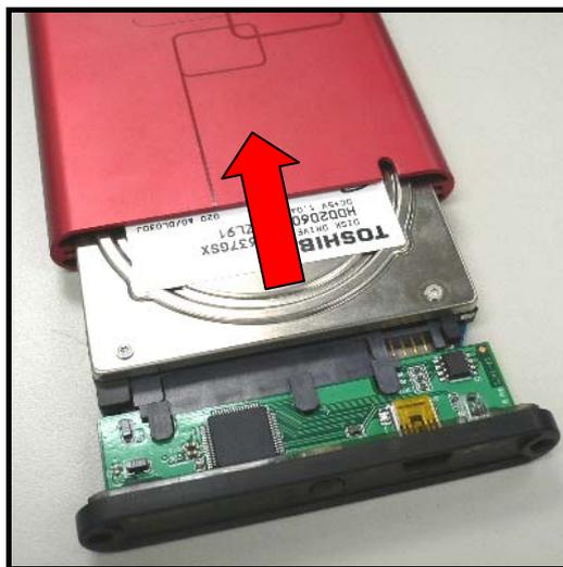
圖 5. 插入接有硬碟的控制板並重新鎖上螺絲
