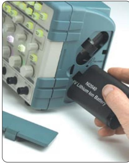
▶ 利用熱插拔的電池，享有幾乎不使用 AC 電源來供電的自由感。
