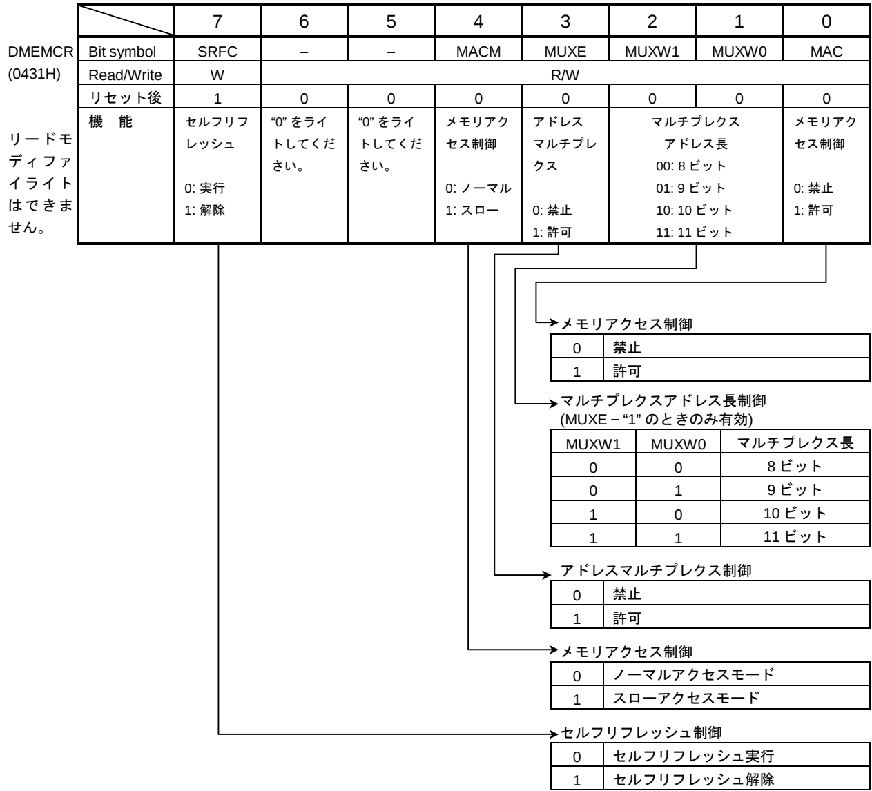
図 3.10.2 DRAM メモリアクセスコントロールレジスタ
