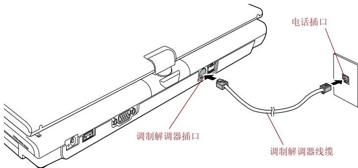
图 4-25 连接内置调制解调器
