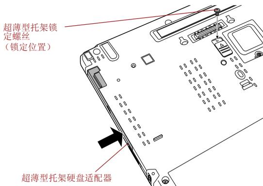
图 4-18 插入超薄型托架硬盘适配器
