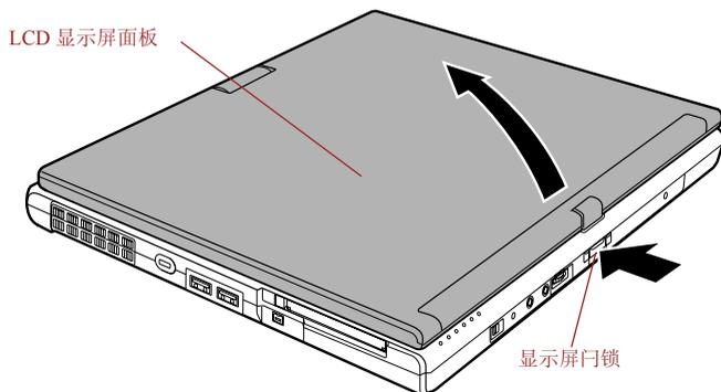
图 3-7 打开 LCD 显示面板
