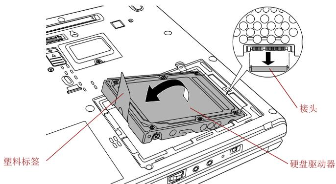
图 8-20 安装硬盘驱动器
