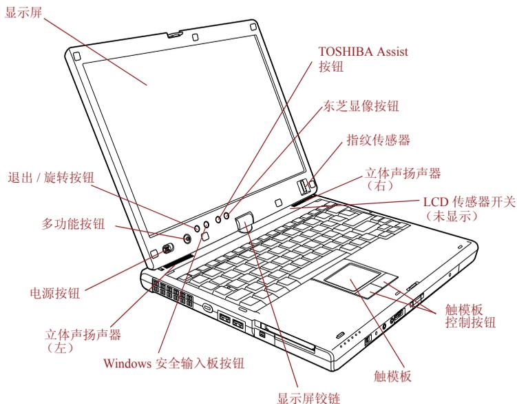
图 2-6 LCD 显示面板打开时电脑的前侧
