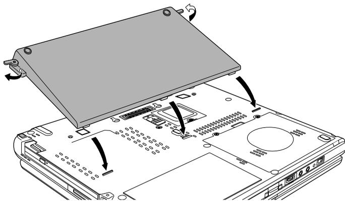
图 8-14 放置 Slice Expansion Battery（薄型扩展电池组）
