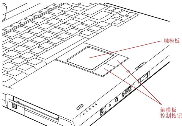
图 4-1 触模板和触模板控制按钮
