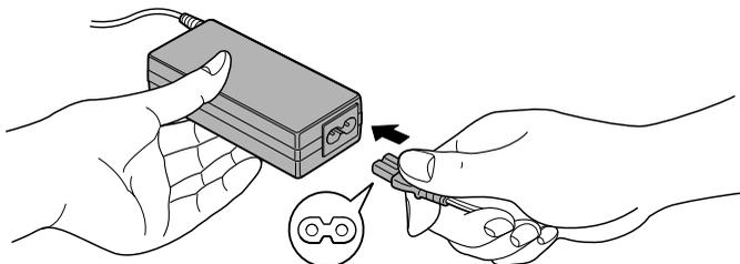
图 3-4 将电源线连接至 AC 适配器（2 脚插头）
