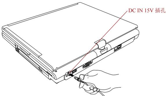
图 3-6 将适配器连接至电脑
