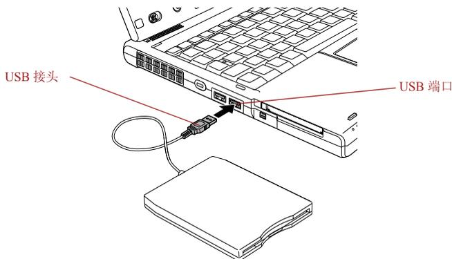
图 4-16 连接 USB 软盘驱动器
