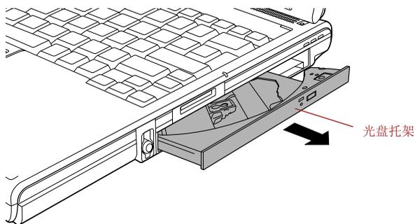
图 4-20 拉开光盘托架
