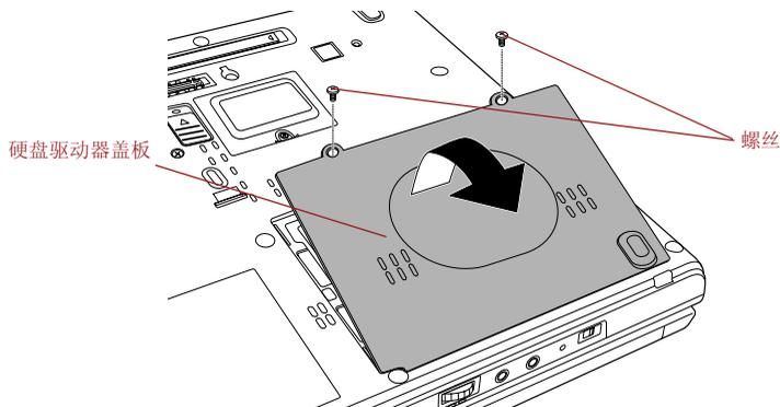
图 8-18 取出硬盘驱动器盖板
