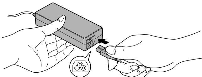
图 3-5 将电源线连接至 AC 适配器（3 脚插头）
