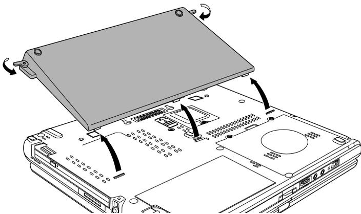
图 8-17 取出 Slice Expansion Battery（薄型扩展电池组）
