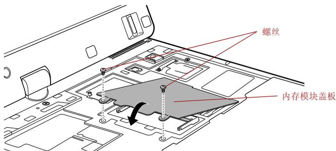
图 8-11 合上内存模块插槽盖板
