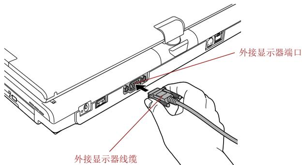
图 8-24 将显示器线缆连接到外接显示器端口
