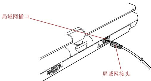
图 4-26 连接网线
