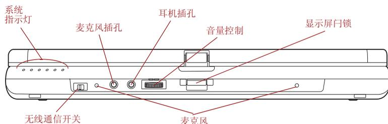
图 2-1 LCD 显示屏面板关闭时电脑的前侧
