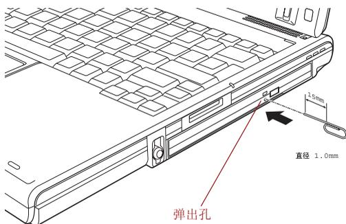
图 4-24 使用弹出孔手动弹出托盘
