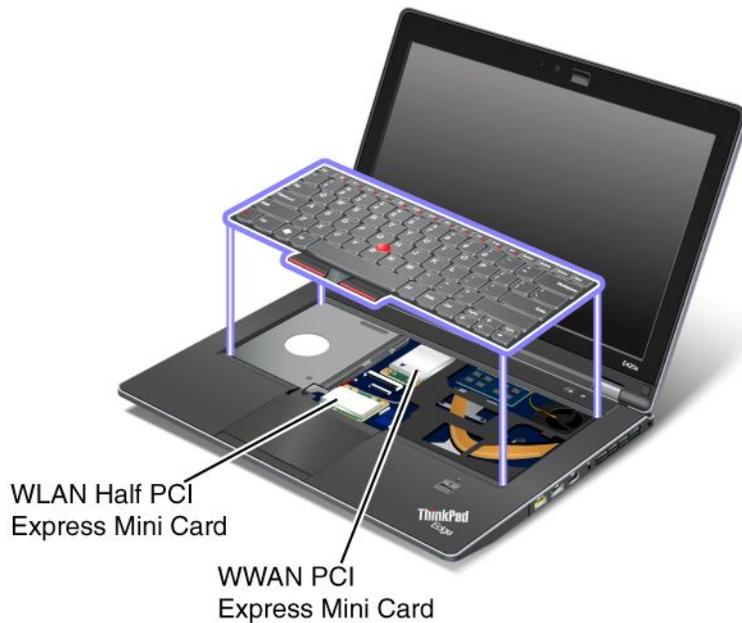
如果您的计算机没有预装集成无线 PCI Express 迷你卡，那么可以安装此卡。要进行安装，请按照第 79 页“安装和更换用于无线局域网/WiMAX 连接的 PCI Express 迷你卡”或第 82 页“安装和更换用于无线广域网连接的 PCI Express 微型卡”中的过程进行操作。
