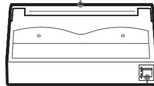
如果开关下降，表示数据可以写入磁带，也可以从磁带擦除。↓
