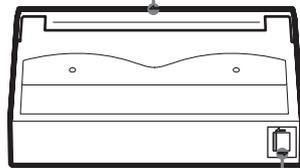
如果开关移到左侧，表示数据可以写入磁带，也可以从磁带擦除。
