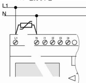
为了抑制浪涌电压, 请安装压敏电阻 (MOV), 其运行电压至少比额定电压高 20%。
