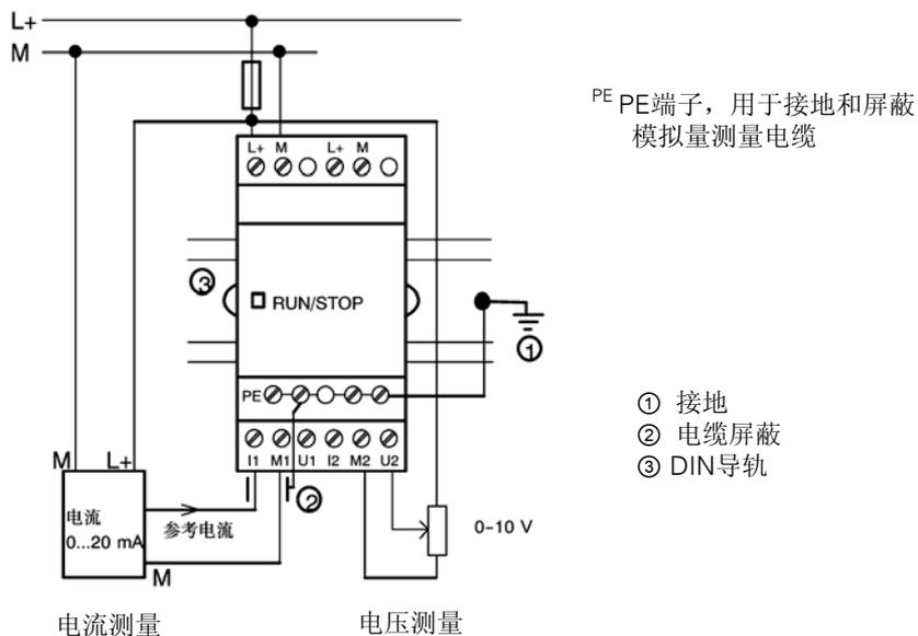
上面的示意图举例说明了四线电流测量和两线电压测量。
