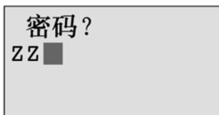
为了避免意外删除电路程序，系统将提示您输入密码（假如您已指定了一个密码）。
