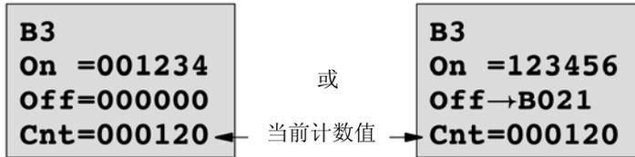
您可以修改开/关阈值。但当接通/断开阈值表示其他功能的结果时，不能修改阈值（参见章节 4.4.13 中的示例，B021）。
