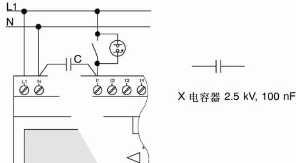
应考虑使用的 2 线接近开关的静态电流。某些 2 线接近开关的静态电流, 其大小足以在 LOGO!输入端触发一个逻辑“1”信号。因此, 必须比较接近开关的静态电流与附录 A 中的输入技术数据。
