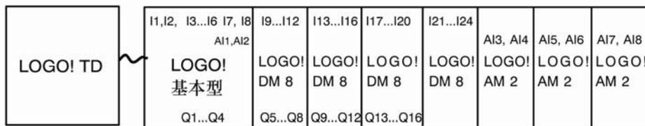
对于任意一种设置，可以插入模拟量输出模块，该模块最多具有2个模拟量输出。
