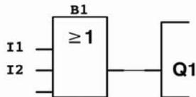
在此电路程序中，OR（或）功能块的最后两个输入不需要使用。可以将没有使用的输入标记为“x”。输入“x”字符两次：
