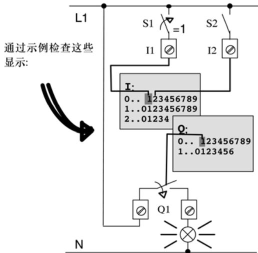
如果开关 S1 闭合, 则输入 I1 状态为“高电平”。LOGO! 通过电路程序计算输出的状态。
