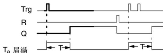
时序图中的加粗部分也显示在保持性接通延迟图标上。
