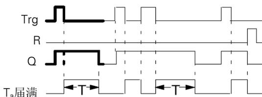
时序图中的加粗部分也显示在断开延迟图标上。
