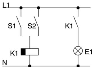
您已了解该电路的第一部分。S1和S2开关控制一个继电器。该继电器用于接通负载E1，并在延时12分钟后断开负载。
