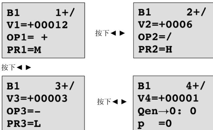
使用◀和▶可以在画面上定位到所需的运算数、运算符和运算优先级。如果需要修改某值时, 可以使用▲和▼键来浏览每个值的选择。当光标位于 V1 至 V4 数值行时, 可以使用◀键从一个画面返回到之前的画面, 使用▶键从 PR1 至 PR3 优先级行导航到下一个画面。点击 OK 键接受改动。
