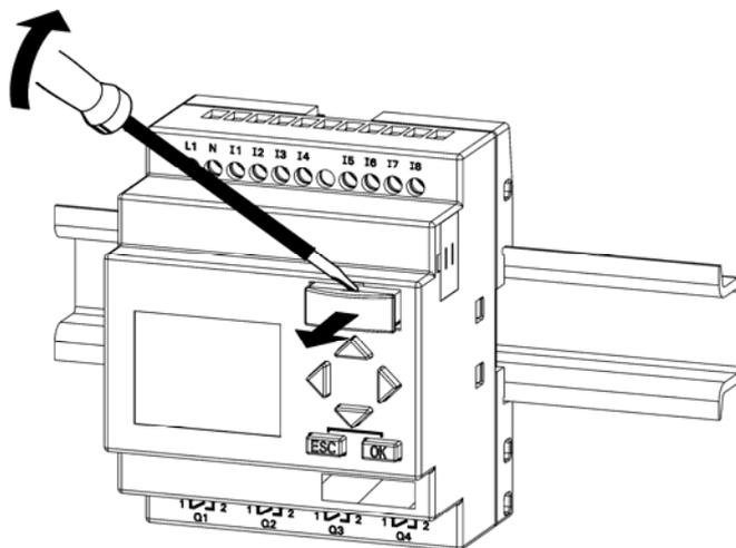
要拆卸电池卡或存储器电池卡，滑动螺丝刀从卡上表面的插槽插入，直至插到背面，然后卡住螺丝刀，用手将卡拔出。
