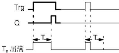
时序图中的加粗部分也显示在接通延迟图标上。
