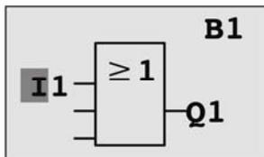
按下 OK 键。I1 连接到 OR（或）功能块的输入上。接着，光标跳到 OR（或）功能块的下一个输入上。
