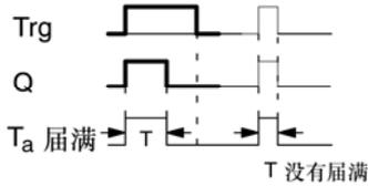
时序图中的加粗部分也显示在脉宽触发继电器的图标上。
