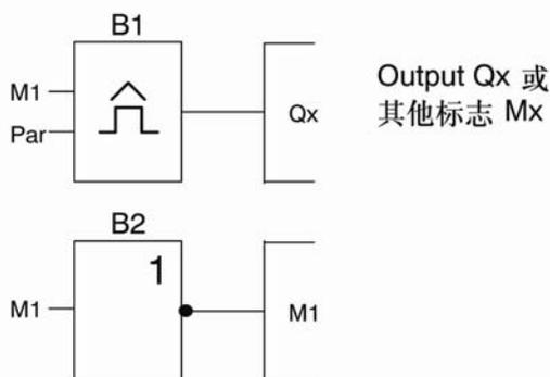
2. 按照下列所示来对阈值触发器进行配置。由于存在取反标志，在每个程序周期都会生成一个脉冲。触发器间隔被设为 2 秒。
