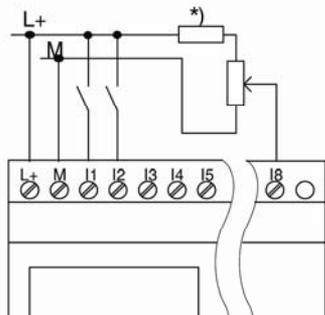
该LOGO!型号的输入不是隔离输入，因此需要一个公共的参考地（机架接地）。使用LOGO!12/24RC/RCo和LOGO!24/240模块，可以获得电源电压和底盘地之间的模拟量信号（\*=串联电阻，电压24VDC）。
