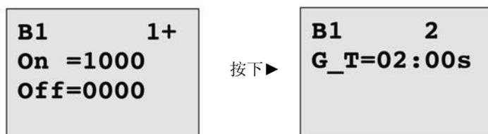
3. 限制启动电路程序并将 LOGO! 切换至参数赋值模式下。在此模式下查看触发器参数。
