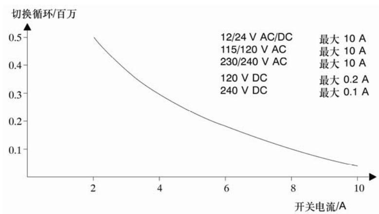
高电感负载的接触的切换能力和使用寿命，根据IEC947-5-1 DC 13/AC 15（接触器、电磁铁线圈、电机）
