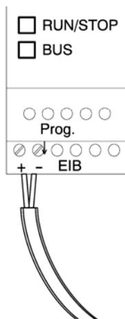
只能使用红黑线对的导线，不能使用白黄线对的导线。
