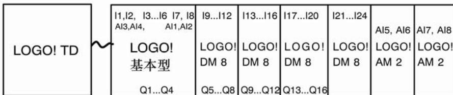
使用模拟量输入达到 LOGO! 的最大设置—使用两个模拟量输入
