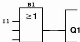
现在将输入I2 连接到OR（或）功能块的输入上。您已经知道怎么操作了：
