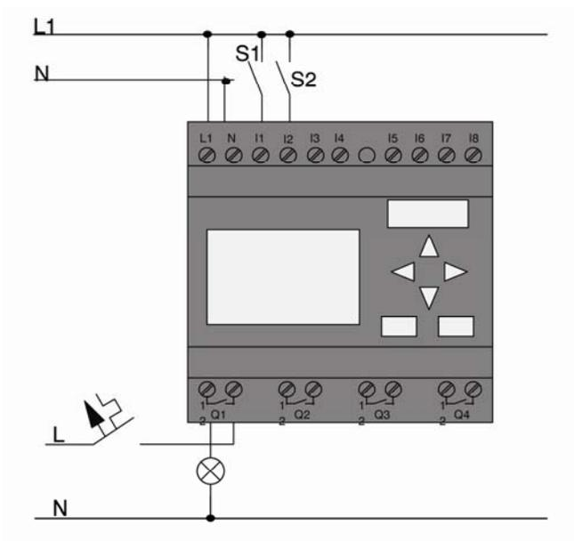
S1 接通输入 I1；而 S2 接通输入 I2。负载则连接到继电器 Q1 上。
