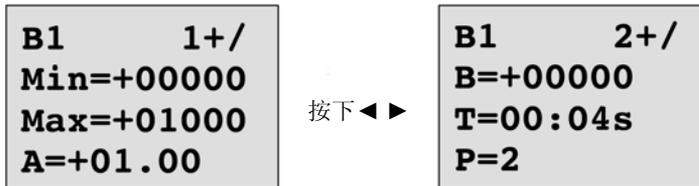
按下 ◀ 和 ▶ 键导航到 Min, Max, A, B, T 和 P 参数。对于值的每个数字，使用 ▲ 和 ▼ 键滚动选取值。按下 ▶ 从第一个画面的最后一行导航到第二画面，并使用 ◀ 键从第二画面的最顶行导航到第一个画面。点击 OK 键接受改动。
