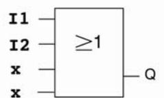
此图中，输入I1和I2连接到OR（或）功能块。功能块的最后两个输入没有使用，电路程序的创建人员将它标识为“x”。
