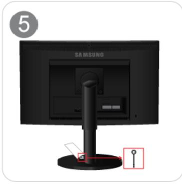
底座安装完成后，按图中所示立起显示器。现在可以拔出止动销，以便调整支架。
