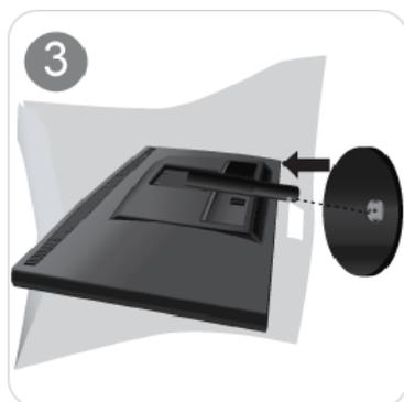
按图中所示方向，将支架底座插入支架连接部分。
