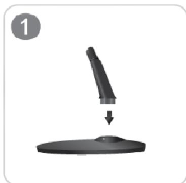
按照如图所示的方向，将支架支杆插入支架。
