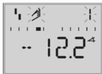
若代码数字与手形标志同时闪烁, 则可转动
