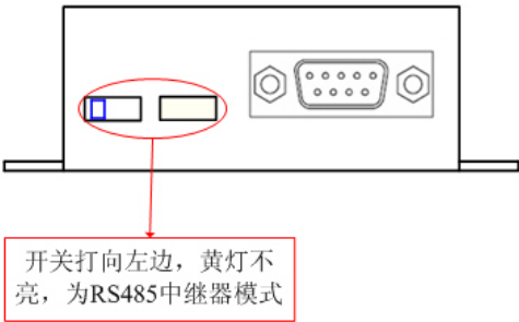
图 5.4 RS485 中继器模式的设置方式
