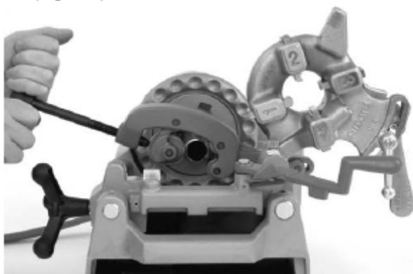
图9 — 用354割刀切割管子
