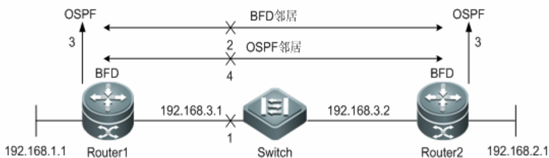
图表 4 BFD 会话检测故障处理过程
