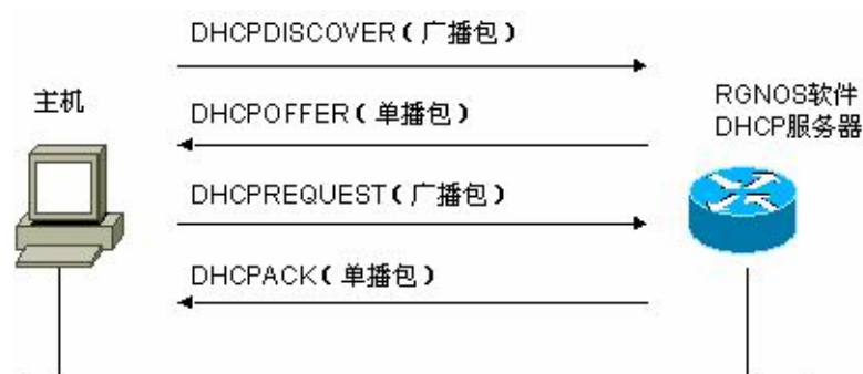
图 1 DHCP 基本工作流程
