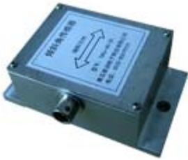
本产品采用了微机械结构技术,集成磁敏电阻芯片以及单片机信号处理技术,能够精确测量、跟踪倾斜角的大小和变化。微机械技术的采用很好地解决了一般倾斜角传感器抗振性差的缺陷。集成磁敏电阻芯片采用非接触的方式感应角度的变化,大大提高了产品的可靠性和频响性能;单片机技术的采用提高了产品温度补偿的精度,使产品在高温使用时的漂移量很小。本产品是传统重力摆结构倾斜角传感器的换代产品。
