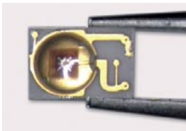
图 5. LUXEON 二极管的正确夹持示意图。
