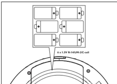
2 請安裝 6 顆 1.5V R14/UM-2/C-cell 電池，並依正負極指示 (+/-) 正確安裝。
