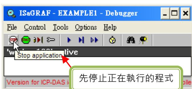
**連結 NG** 如果 "ISaGRAF Debugger" 視窗出現 "Disconnected", 表示您的電腦和  $\mu$ PAC-5x07(P) 控制器並沒有連接成功。
