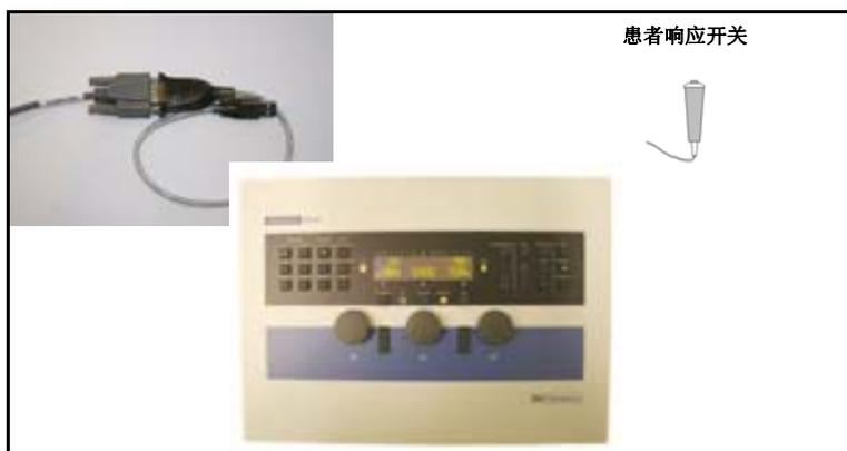
图 4 用于具备 USB 端口的 PC 或便携式电脑的 USB/RS232 接口，或用于具备串行端口的 PC 或便携式电脑的 RS232 电缆
