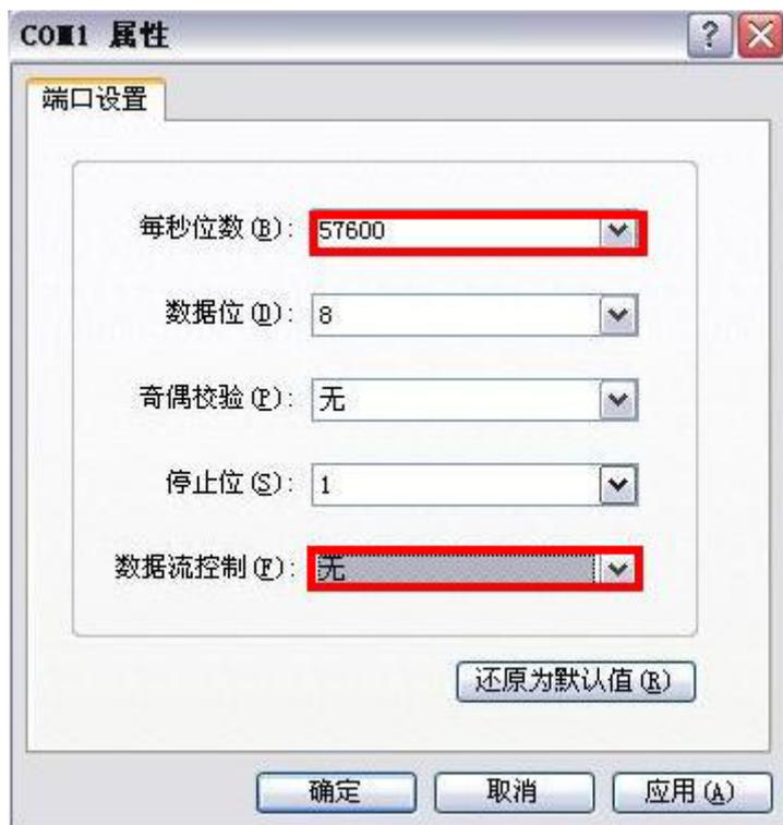
当所有的连接参数都设置好以后，打开NewMsg-44BOX电源开关，系统会出现启动界面。选择超级终端“文件”菜单下的“另存为…”，保存该连接设置，以便于以后再连接时就不必重新执行以上设置了。
