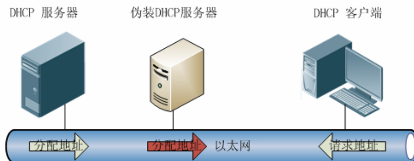
图 2 存在伪装 DHCP 服务器的网络
