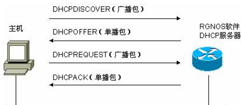
图 1 DHCP 基本工作流程
