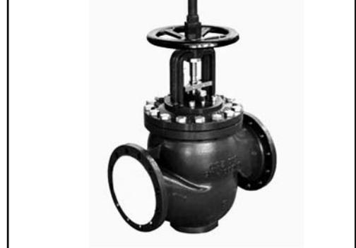
MSV-F2 – ручные клапаны с предварительной настройкой пропускной способности. Их используют для балансировки расходов в циркуляционных кольцах систем отопления и охлаждения.
