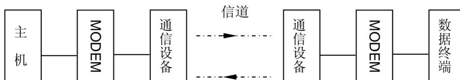
图 1-1 MODEM 的连接示意
