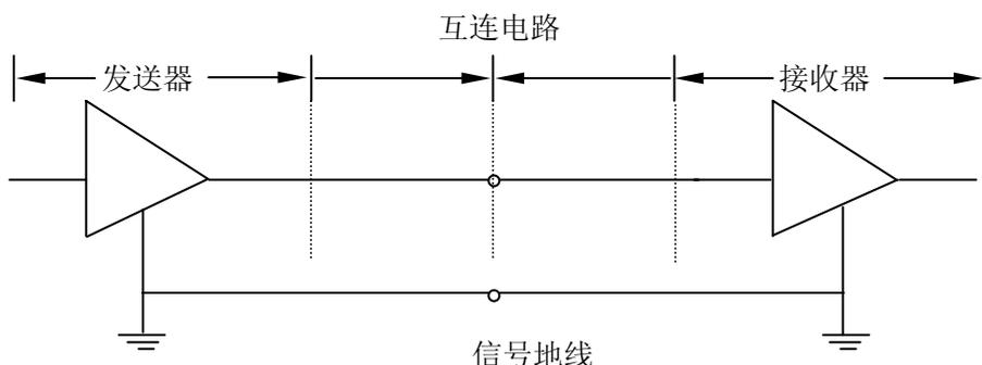
图 1-2 RS-232C 接口电路
