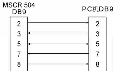
图 2-11 串口信号连接示意
