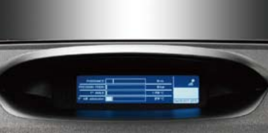
パワー (ch)、ブレーキ圧 (bar)、オイル温度 (℃)、吸気温度 (℃)
