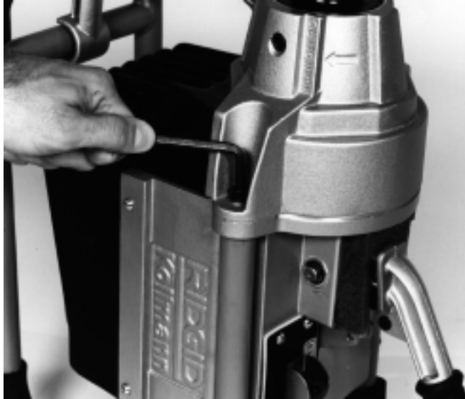
图 11 拆卸卡爪组件示意图
