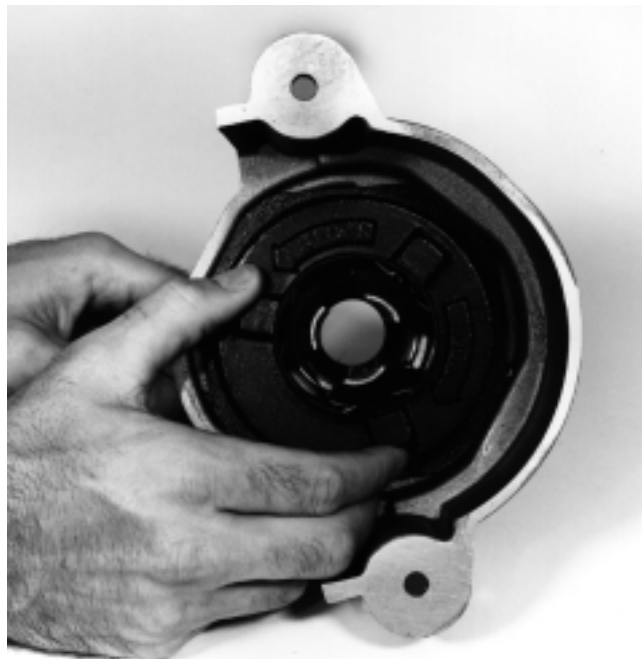
图12 卡爪端盖拆卸
