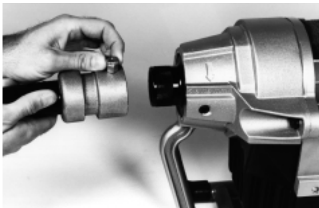
图 4 – 后引导管安装
